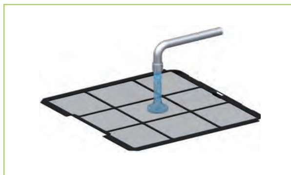
Obr. 53: Čištění vlažnou vodou
